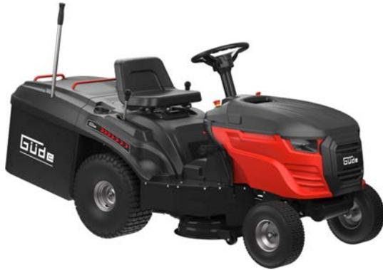
Der Rasentraktor GAR 685 T ermöglicht Ihnen auch größere Rasenflächen schnell, effizient und ohne Anstrengung zu mähen. Mit seinem 5,6 PS starken Motor und einem 210 l großen Fangsack eignet er sich für Flächen von bis zu 4000 m<sup>2</sup>.
