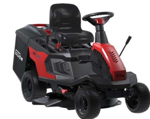
Der Aufsitzrasenmäher GAR 651 ermöglicht Ihnen auch größere Rasenflächen schnell, effizient und ohne Anstrengung zu mähen. Mit seinem 6 PS starken Motor und einem 150 l großen Fangsack eignet er sich für Flächen von bis zu 3000 m<sup>2</sup>.
