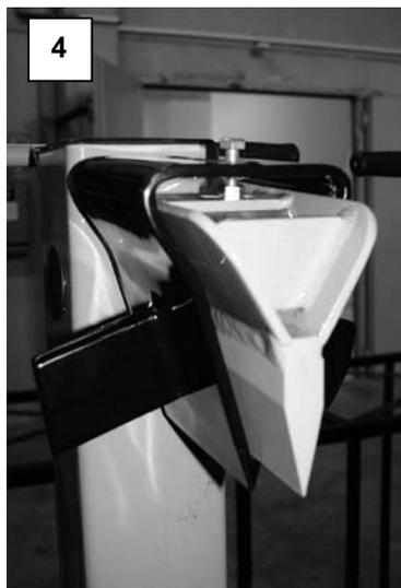
4. Fixierschraube und Mutter so ausrichten, dass das Spaltkreuz ganz nach oben gezogen wird.
