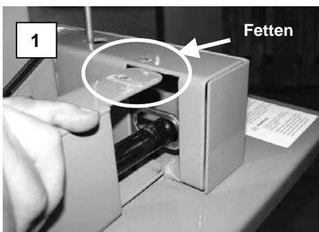
1. Bedienarm einsetzen und das Rohr in die Aussparung der Querverbindung einführen.
