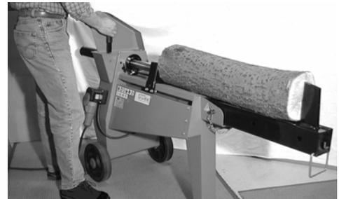
Bei weichem Holz die Hebel bis zur Mitte ihres Schaftweges ziehen: der Klotzvorschieber arbeitet schneller, doch mit geringer Schubkraft. Bei besonders hartem oder trockenem Holz die Hebel bis zum Anschlag ziehen. Der Klotzvorschieber arbeitet nun langsamer, aber mit höchster Leistung, was ein leichteres Spalten von hartem Holz ermöglicht. Die Geschwindigkeit kann auch während des Spaltvorganges verstellt werden, indem die Hebel einfach losgelassen oder gezogen werden.
