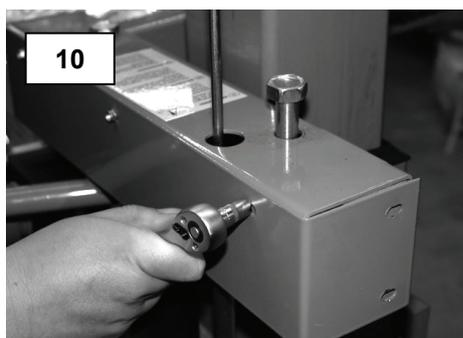
6. Odšroubujte konzolu pro obslužné rameno (obr. 10)
