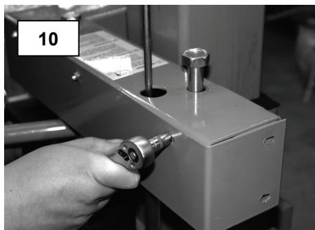
1. Schroef de console voor de bedieningsarmen af (afb. 10).
