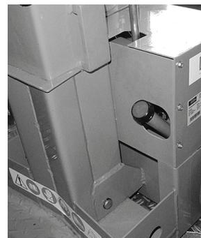
Hydraulikölwechsel: Positionieren Sie einen geeigneten Behälter unter der Hydraulikölablassschraube (**Abb. 8 Punkt 11**) und drehen Sie die Ölablassschraube heraus.
