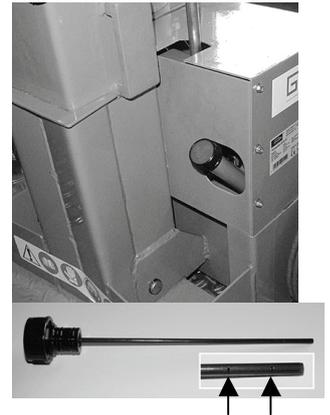
Sada ponovno uvrnite vijak za ispuštanje ulja. **Upozorenje – spriječite prodor bilo kakve nečistoće u unutrašnjost spremnika hidrauličnog ulja.** Sada ponovno napunite spremnik hidrauličnog ulja i pomoću mjerila razine ulja provjerite da li količina hidrauličnog ulja udovoljava zahtjevima odnosno doseže oznaku ispravne razine. **Upozorenje: Ulje se smije dopunjavati samo dok je stupac postrojenja za cijepanje uvučen prema unutar!**
