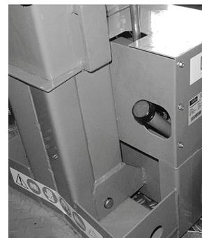
Schimb de ulei hidraulic: Poziție un recipient adecvat în conformitate cu fișa de evacuare a uleiului hidraulic (Fig. 8 punctul 11) și deșurubați mufa de scurgere de ulei.
