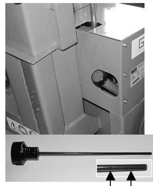
Teraz vypúšťaciu skrutku opäť zaskrutkujte. **Pozor, do nádrže hydraulického oleja sa nesmú za žiadnych okolností dostať nečistoty.** Teraz nádrž na hydraulický olej naplňte a pomocou olejovej mierky skontrolujte, či je množstvo hydraulického oleja v nádrži správne. **Pozor: Olej doplňujte vždy iba pri zasunutom štiepacom stípiku!**
