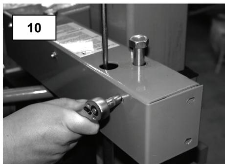
1. Odskrutkujte konzolu pre obslužné rameno (obr. 10).
