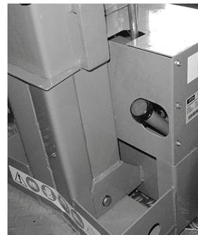
Hidraulikus olaj csere: Az olaj kifolyó nyílása alá helyezzen erre a célra megfelelő edényt (8.ábra, 11.pont) és a csavarozza ki a csavart.
