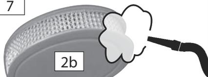
**DE** Papierfilter nur mit Druckluft reinigen!
