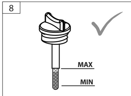
DE **Aus Gründen der Qualitätssicherung wird jedes Gerät einem Probelauf unterzogen und mit Motorenöl befüllt. Vor dem Transport wird das Öl wieder abgelassen, es können sich jedoch Rückstände von Motorenöl am Messstab befinden. Bitte trotzdem Ölstand gewissenhaft überprüfen und Motorenöl nachfüllen.**
