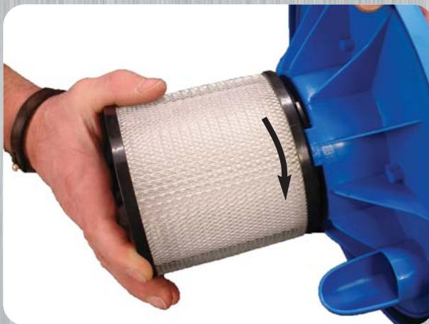
**2.3)** Reinigen Sie die Andruckfläche am Saugerkopf und arretieren Sie den Filter durch Drehen im Uhrzeigersinn. Achten Sie beim Wiedereinbau des Faltenfilters unbedingt auf die korrekte Verbindung des Filters mit dem Oberteil.
