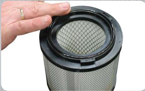
**2.2) TIPP:** Fetten Sie den neuen Dichtring leicht mit Pflanzenfett (Butter oder Margarine) oder Vaseline ein, dann lässt sich der Filter problemlos in den Bajonettverschluss am Saugerkopf eindrehen. (siehe 2.3)
