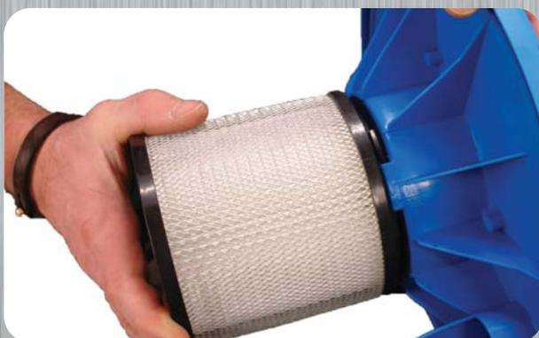
**1.4)** Reinigen Sie die Andruckfläche am Saugerkopf und arretieren Sie den Filter durch Drehen im Uhrzeigersinn. Achten Sie beim Wiedereinbau des Faltenfilters unbedingt auf die korrekte Verbindung des Filters mit dem Oberteil.
