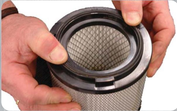
**2)** Achtung! Beschädigte bzw. verschlissene Dichtringe müssen umgehend durch den **beiliegenden Ersatzdichtring** ersetzt werden, da sonst Staub oder Asche in die Umgebungsluft gelangen könnte.
