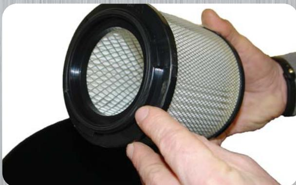
**1.3)** Achten Sie beim Wiedereinbau des Faltenfilters unbedingt auf den korrekten Sitz der Filterdichtung.
