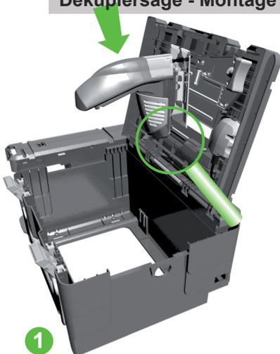
1. Öffnen Sie den Deckel des Koffers und entnehmen Sie alle Werkzeuge und den Einsatz. Nehmen Sie die Dekupiersäge in Ihre rechte Hand und drücken Sie die Hinterseite der Grundplatte in das Ablagefach an der Unterseite des Deckels.
