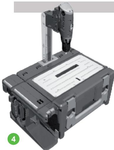
4. Montieren Sie das benötigte Werkzeug in die Spannvorrichtung des Bohrers und ziehen Sie fest. Müssen Sie die Höhe korrigieren, folgen Sie bitte der Anleitung in Abschnitt 3.
