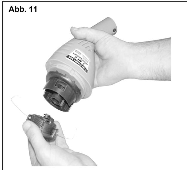
Durch Eindrücken der Haltetaschen mit Daumen und Zeigefinger lässt sich der Haltekorb der Fadenspule entnehmen (Abb. 10).
