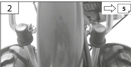
**DE** Wählen Sie die richtige Stellung der Lenkgabel. Um die Lenkgabel zu drehen muss das Lenkgestänge gelöst und wieder fixiert werden. Das jeweilige Anbaugerät (z. B. Schneeschild, etc.) bestimmen die Position der Lenkgabel.
