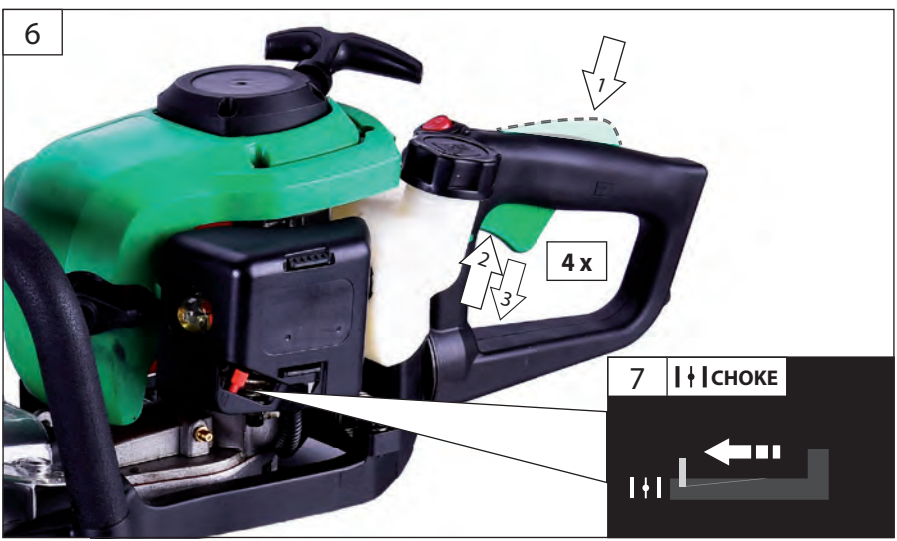
D Anwerfseil ca. 3-5x kräftig ziehen bis erste hörbare Zündung erfolgt.
