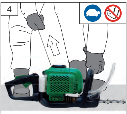
D Anwerfseil ca. 3-5x kräftig ziehen bis erste hörbare Zündung erfolgt.
